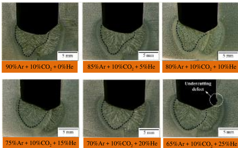
รูปที่ 9.32 อิทธิพลของแก๊สฮีเลียมที่ผสมใน Ar + CO 2 + He ของขบวนการเชื่อม GMAW
