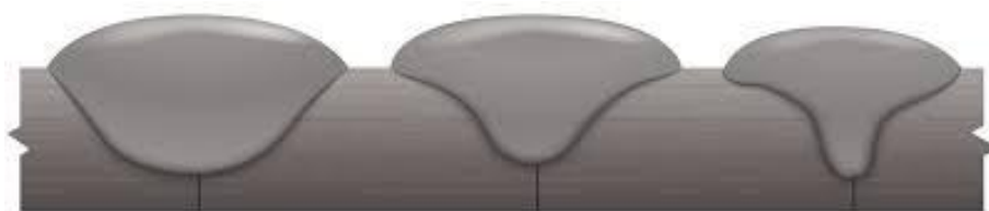
แบบลัดวงจร 100% \text{CO}_2 แบบละออง 90% \text{Ar}+10\%\text{CO}_2 แบบละออง 98% \text{Ar}+2\%\text{O}_2
