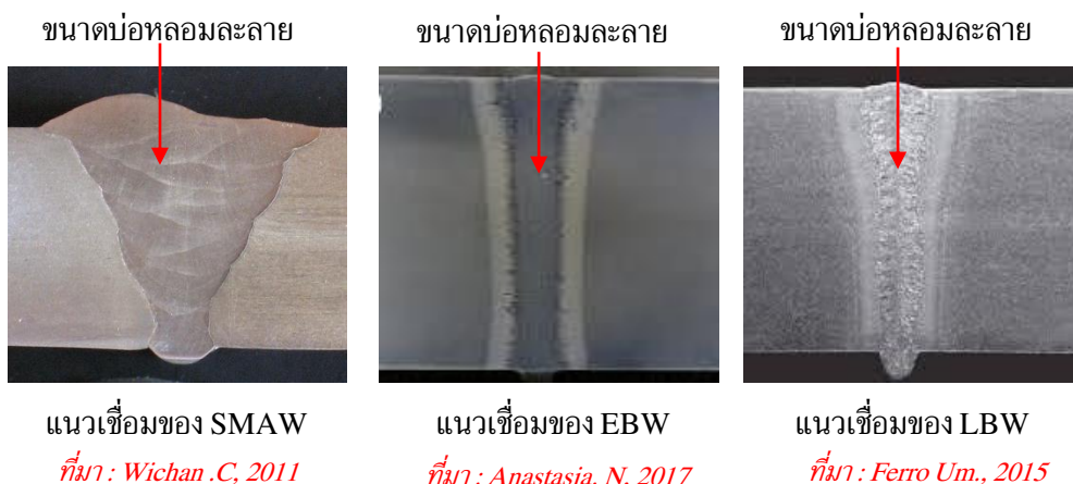
รูปที่ 9.12 แนวเชื่อมที่เกิดจากการเชื่อมที่สร้างบ่อหลอมละลายได้แตกต่างกัน
